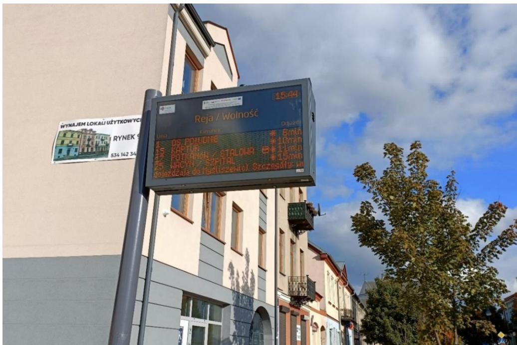
Fot. 7.3 System Dynamicznej Informacji Pasażerskiej w Radomiu.
